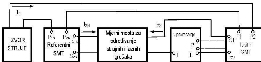
Slika 1. - Princip utvrđivanja grešaka strujnog mjernog transformatora
