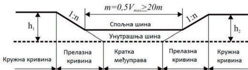
Слика 39. Надвишење међуправе између двије кружне кривине
