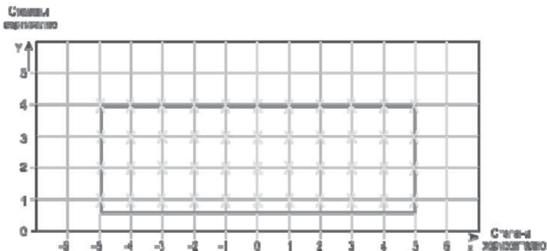
Слика У-25. Мрежа тачака које се користе за израчунавање просечног интензитета светала осе рулне стазе и пречке за заустављање
